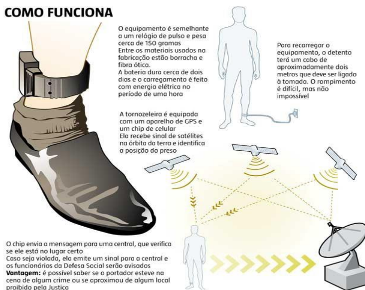
Figura 1 – Esquema da tecnologia de Sistemas de Posicionamento Global (GPS) para rastreamento de presos extra muros.
