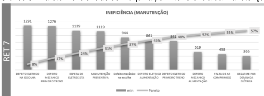
Gráfico 3 - Pareto ineficiências de máquina por interferência da manutenção.
