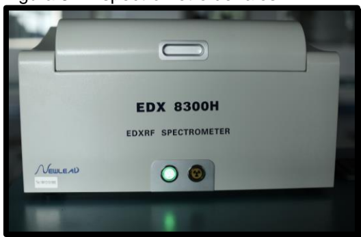
Figura 8 – Espectrômetro de raios-x
