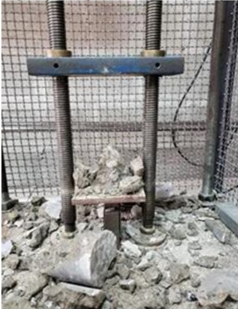
Figura 9 – Ruptura do corpo de prova: Ruptura Cônica (10%)
