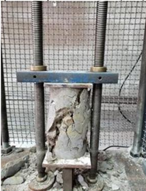
Figura 11 – Ruptura do corpo de prova: Ruptura Cisalhada (50%)
