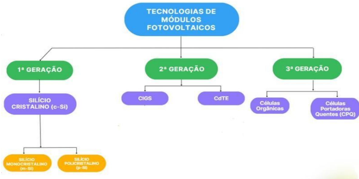
Figura 2 – Gerações dos Módulos Fotovoltaicos
