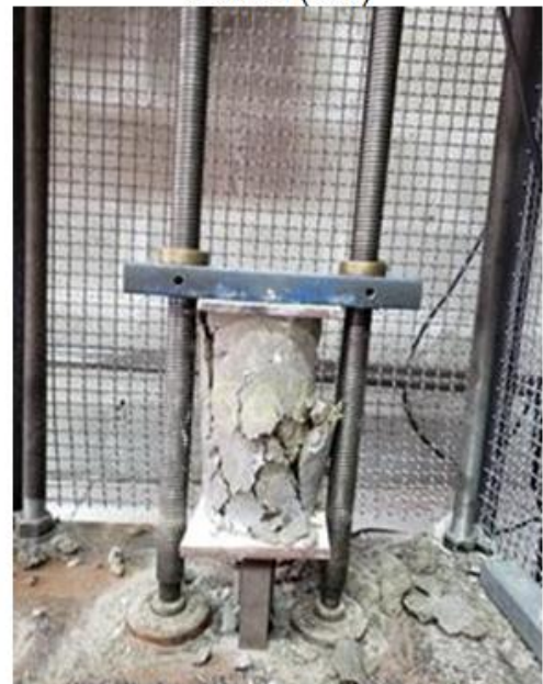
Figura 12 – Ruptura do corpo de prova: Ruptura Colunar em forma de Cones (0%)
