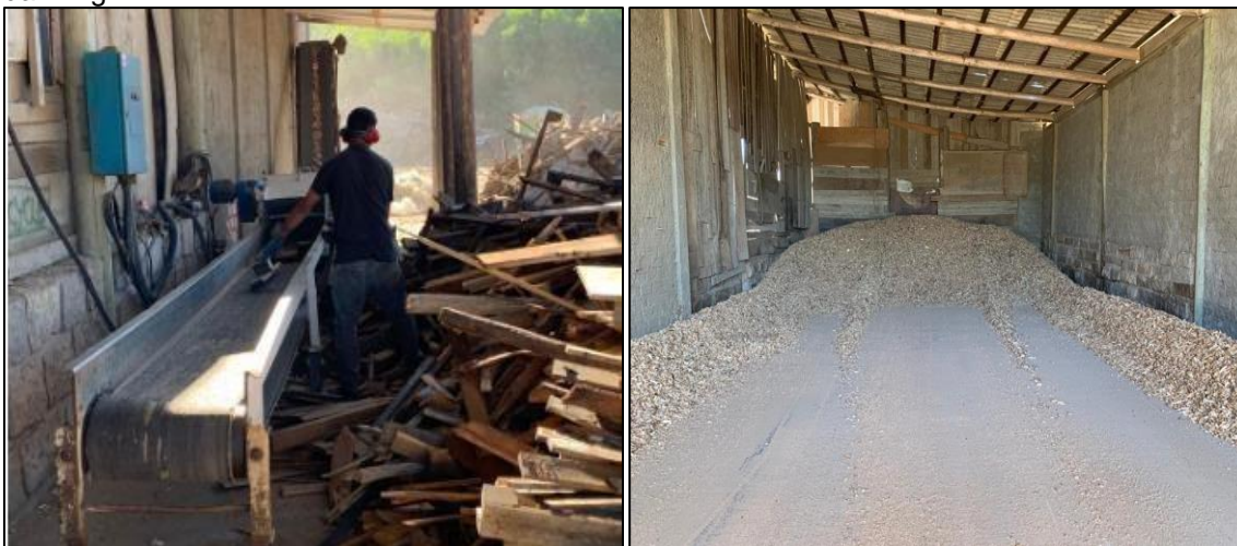
Figura 4 - À esquerda da imagem: operador realizando a cominuição da madeira não tratada. À direita da imagem: Armazenamento dos “cavacos” de madeira.
