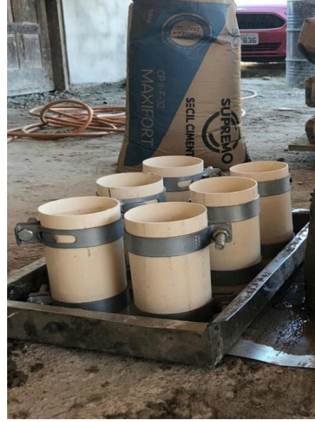
Figura 5 – Corpos de prova (PVC)
