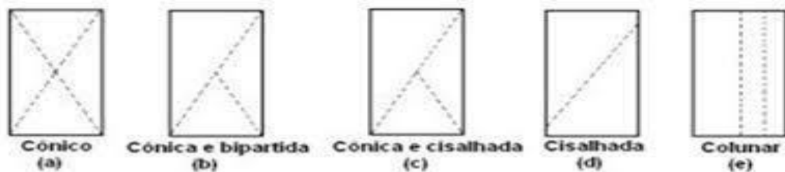
Figura 8 – Tipos de ruptura do corpo de prova
