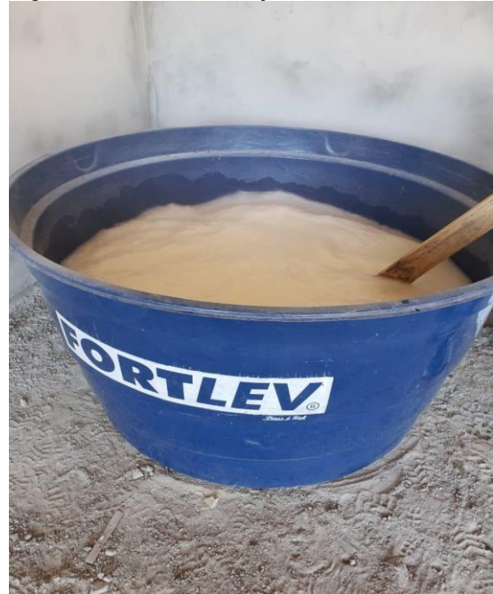
Figura 7 - Cura em solução de hidróxido
