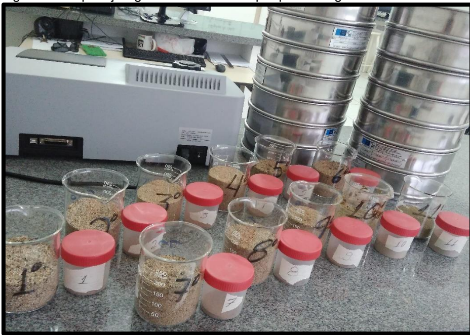
Figura 9 – Separação granulométrica feita por peneiras graduadas
