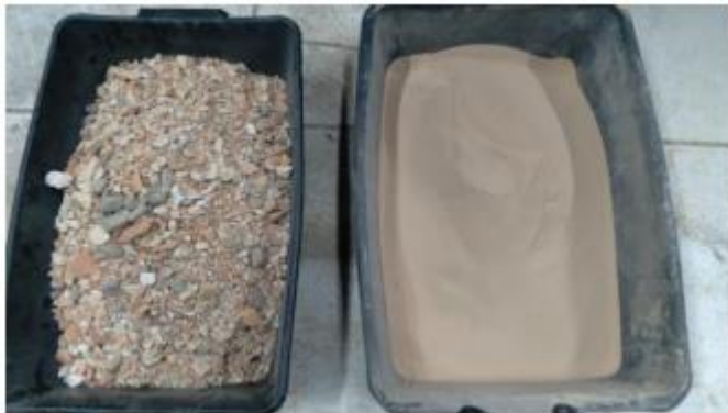
Figura 4 - Material RCC antes e depois de peneirado.
