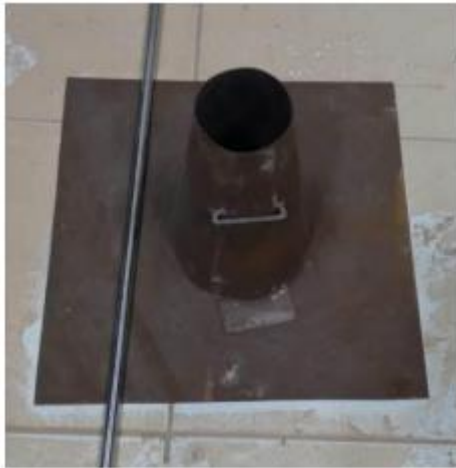
Figura 5 - Molde para Slump-test.
