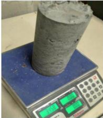
Figura 8 - Verificação da massa específica.
