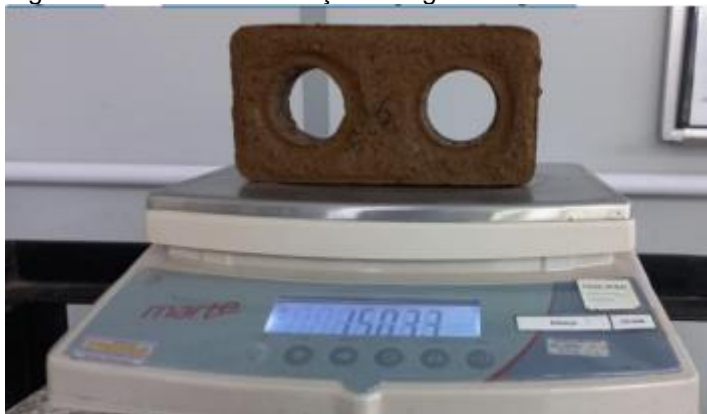
Figura 6 - Ensaio de absorção de água.
