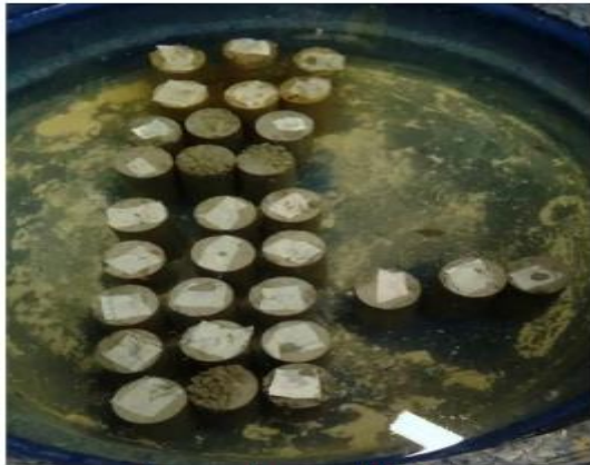
Figura 9 - Cura correspondente em tanque com água.
