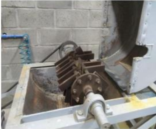
Figura 2 - Britador utilizado para moagem.
