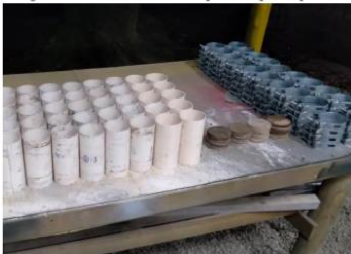
Figura 6 - Moldes utilizados para corpo de prova.
