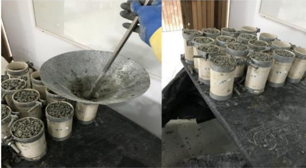
Figura 8 - Moldagem dos corpos de prova cilíndricos.
