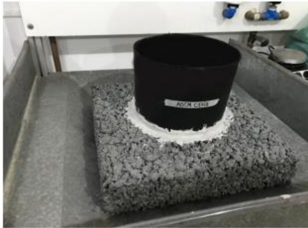
Figura 10 - ensaios de taxa de infiltração nas placas retangulares.
