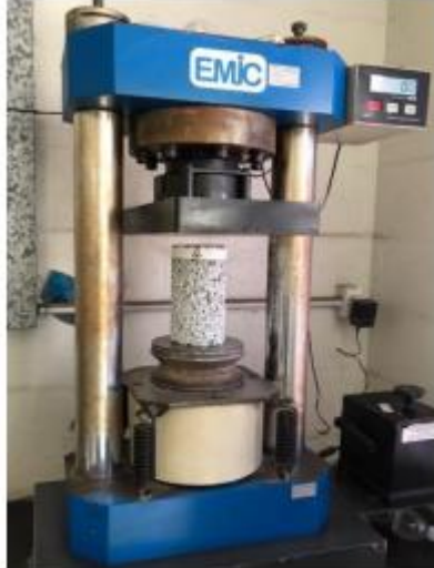
Figura 12 - Ensaio de resistência a compressão axial.
