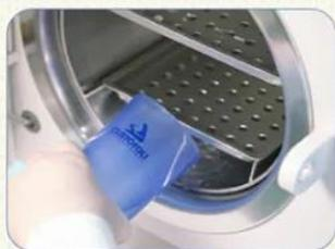
**01** Coloque a água destilada diretamente na câmara de esterilização.
