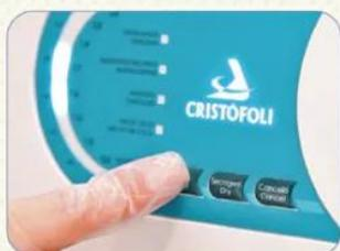
**03** Verifique se a autoclave está conectada à rede elétrica e pressione a tecla **Início** para ligá-la.
