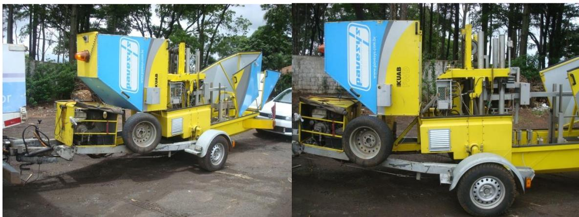
Figura 64 – Exemplo de modelo de centro de calibração de FWD
