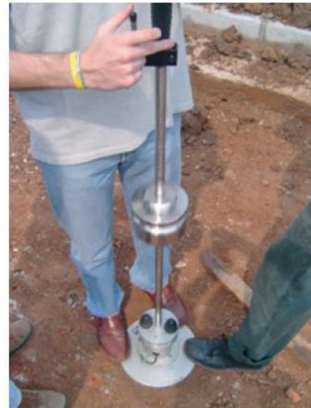
**Figura 10.4** Equipamento de avaliação expedita do módulo elástico do pavimento
