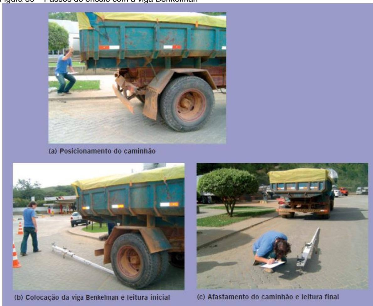
A Figura 60 mostra o esquema de medidas quando se deseja obter a bacia de deflexão com a viga Benkelman. É um procedimento trabalhoso e de pouca precisão quando realizado com a viga convencional, mas hoje é possível encontrar no país vigas automatizadas, nas quais a leitura dos deslocamentos se faz com medidores elétricos tipo LVDT. Todas as leituras intermediárias devem ser referidas à leitura final, para o cálculo da deflexão no ponto considerado.
