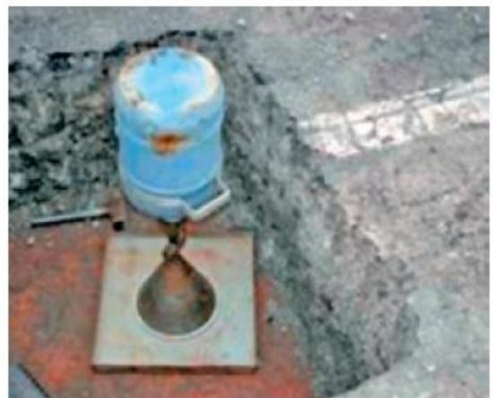
Figura 56 – Exemplo de equipamentos DCP de avaliação estrutural expedita de subleitos e camadas de solo
