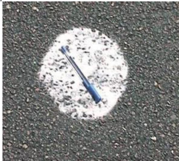
(b) Microrrevestimento asfáltico a frio com macrotextura aberta.
