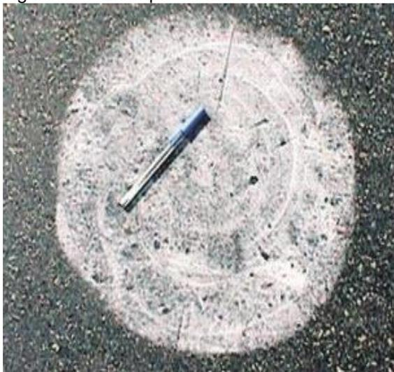
(a) Concreto asfáltico com macrotextura fechada.
