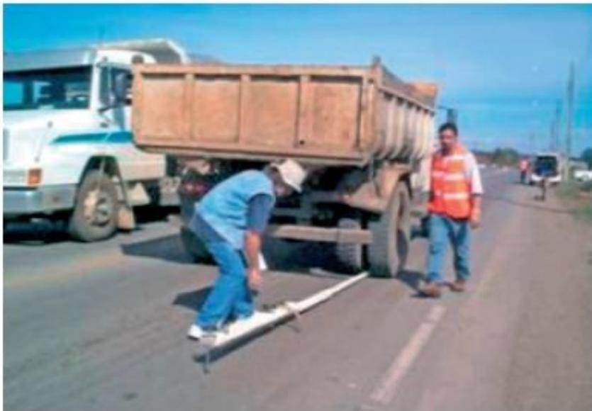
(b) Medida com viga Benkelman em campo
