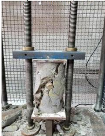
Figura 11 – Ruptura do corpo de prova: Ruptura Cisalhada (50%)
