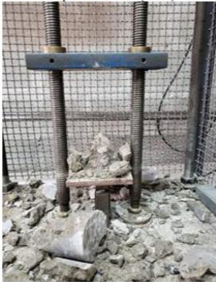
Figura 9 – Ruptura do corpo de prova: Ruptura Cônica (10%)
