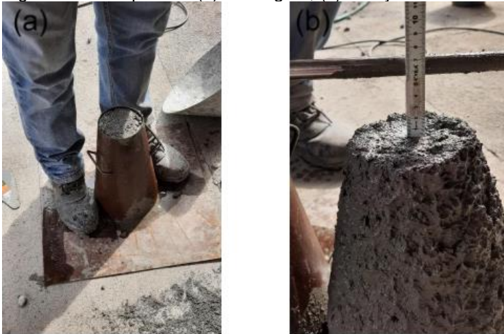
Figura 4 – Slump test – (a) moldagem, (b) aferição.
