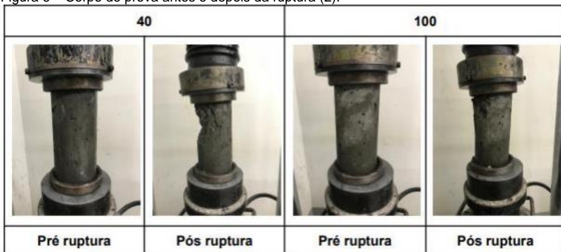
Figura 6 – Corpo de prova antes e depois da ruptura (2).
