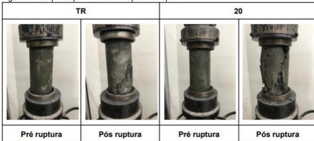
Figura 6 – Corpo de prova antes e depois da ruptura.
