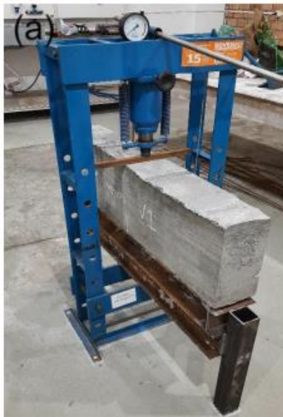
Figura 7: Ensaio de flexão a três pontos (a) prensa utilizada. (b) esquema de posicionamento da viga.
