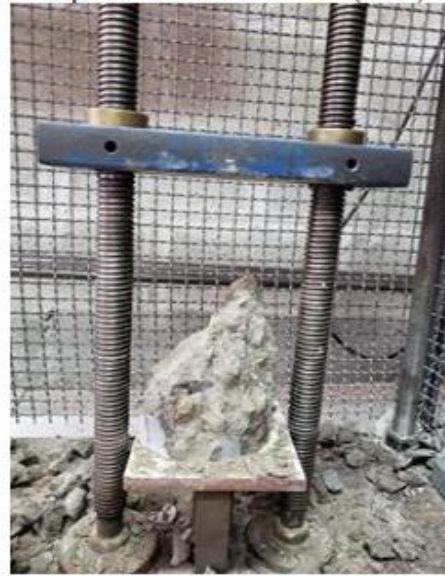
Figura 10 – Ruptura do corpo de prova: Ruptura Cônica Cisalhada (20%)
