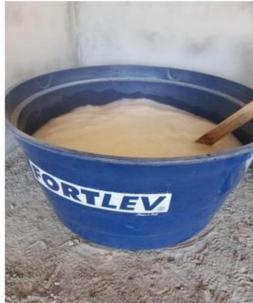
Figura 7 - Cura em solução de hidróxido
