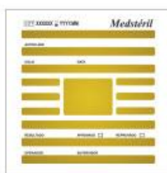
Não Seguro Penetração insuficiente de vapor
