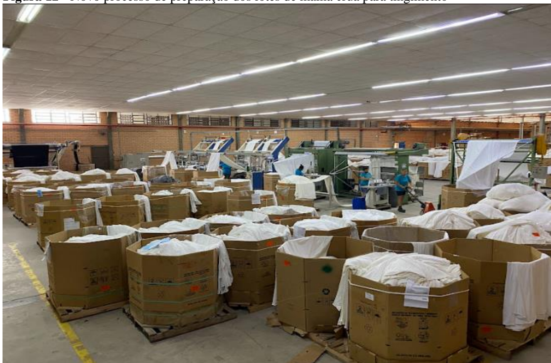
Figura 12 - Novo processo de preparação dos lotes de malha crua para tingimento
