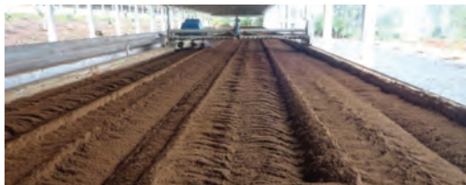
FOTO 07 | Leito de compostagem em estabilização.
