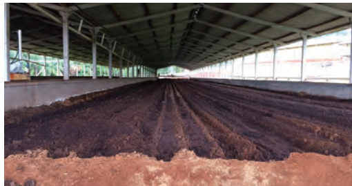
FOTO 08 | Leito de compostagem em estabilização.
