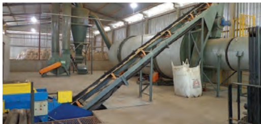
FOTO 30 | Fábrica de maravalha que utiliza a queima direta do biogás para secar o produto.
