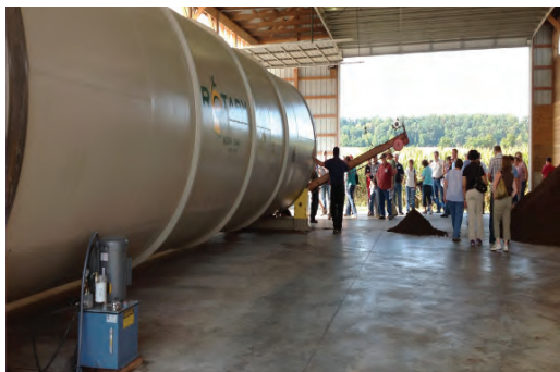
FOTO 45 | Rotoacelerador de tambor rotativo para compostagem de carcaças.
